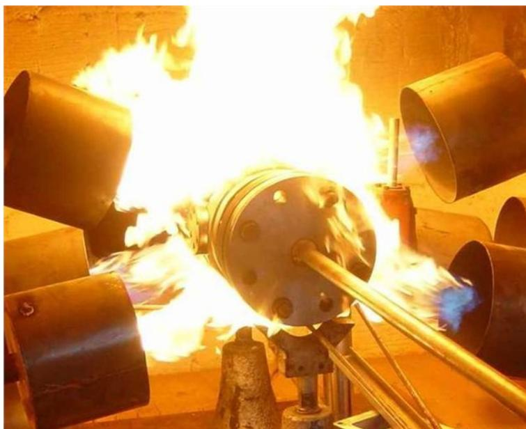
目前广泛被阀门生产厂家用作测试标准的是美国石油学会的API607 和英国国家标准BS6755 2(原理:使燃烧试验用阀门处于关闭状态,充满加压的水,使阀门持续燃烧30 min,期间需保持阀门周围环境温度达到760~980℃,并确定在这段时间内通过阀门并排到大气中的泄漏量。当阀门从燃烧试验的温度冷却下来后,对阀门进行静水压试验以评定阀门壳体以及阀座的耐压能力)。泄漏等级应能满足ANSI B16.104 (ANSI/FCI70.2) 或API598规定的泄漏标准,火灾隔离阀的泄漏等级应为严密关断(TSO)。对于硬密封金属阀座,TSO为V级;对于软密封非金属阀座,TSO应为VI级。用于火灾隔离系统的电缆应该是具有防火性能的耐火电缆,UL1709标准下耐火时间不小于15min。如果不采用耐火电缆,电缆必须采用埋地、耐火电缆槽盒内敷设或远离潜在高火灾危险区域之外敷设。在高火灾危险区域内,火灾紧急隔离阀的动力系统管路尽可能采用ASTM304, 316或321不锈钢管,这些管材自身具有较高的耐火能力,
